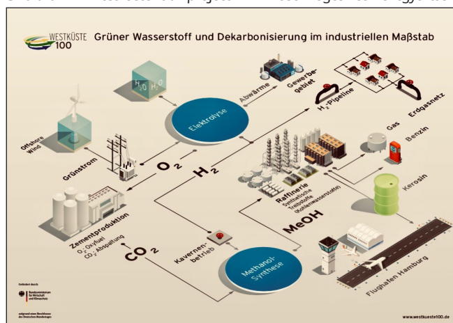
5. ábra: A “Westküste100” project – “klímasemleges” cementgyártás
