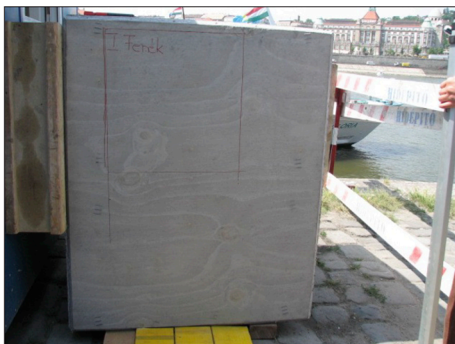
8. kép: Felületi megjelenés szabható natúrhéj alkalmazásakor
