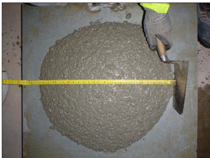
4. ábra: CEM II/A-LL 42,5 N cementtel készített beton helyszíni területmérése és bedolgozása
